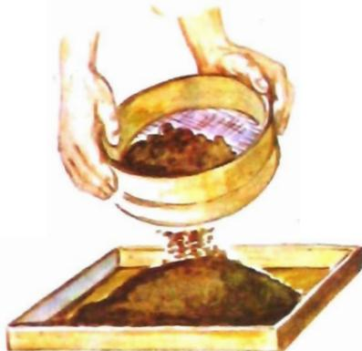
Рис. 17. Сито для просеивания почвы
